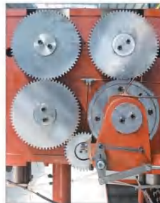
采用气缸控制棘爪机构，插齿会自动抬起，消除噪声；电器采用电磁阀送料气缸间歇送料功能，实现了更大规格产品的生产，拓宽了机器生产的规格。
