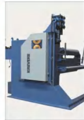
立式全自动校直机，使线材进出自动化。采用卧式线架，便于线材安装，送料时会自动松开线材，保护线材表面的拉伤。
