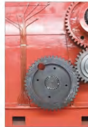
整机油管实现单管对点独立供油，确保在高速运转下实现油膜均匀，油压均衡。
